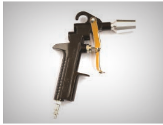
Mod. ACOE 26 Turbo Pistola de soplado profesional. Cuerpo de aluminio inyectado color negro. Mayor comodidad de agarre. Multiplicador que cuadruplica el caudal de aire comprimido. Ref. oAC26T
